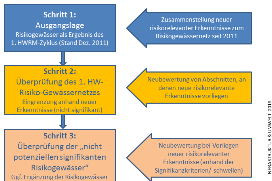
Abbildung 15: Arbeitsschritte der vorläufigen Bewertung im 2. Zyklus zur Überprüfung der Gewässer mit potenziell signifikantem Hochwasserrisiko
